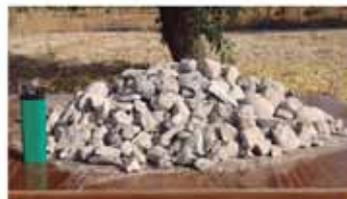
**FRACCIÓN 10/20:** Fabricación de hormigones compactos / Relleno de zanjas / Drenajes.
