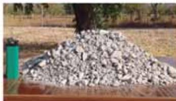
**FRACCIÓN 0/20:** Bacheo y arreglo de caminos y explanadas / Suelo Cemento y Estabilizado / Pantallas, diques y rellenos
