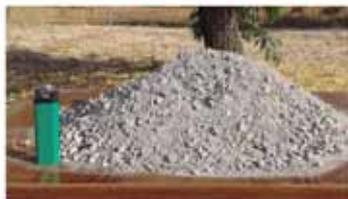
**FRACCIÓN 0/10:** Fabricación de cementos Ecológicos / Prefabricados / Lecho y cubrición de tuberías
