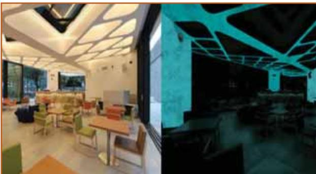
Un ejemplo en interiores del uso de cementos fosforescentes como revestimiento.
